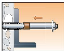
3. Установить анкер в отверстие через прикрепляемую деталь.
