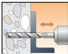
1. Пробурить отверстие необходимого диаметра на требуемую глубину.
